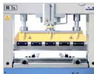
Abkantwerkzeug mit einer Länge von 1.020 mm
