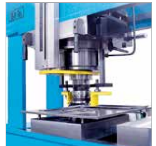
Stanzwerkzeug für Durchmesser von 6 mm bis 160 mm
