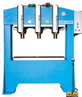
FDM-80/3 E. Tres cabezales independientes
