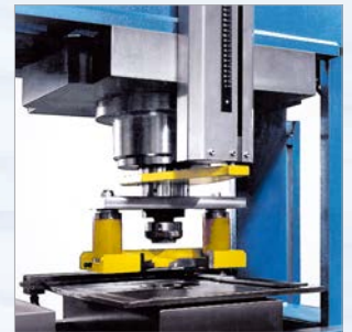
Equipo de punzado para diámetro desde 6 mm hasta 40 mm con pisador elástico antideformación
