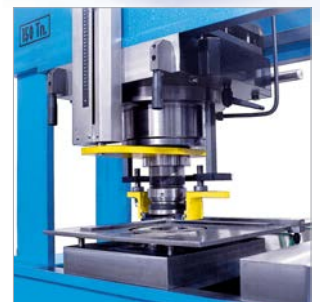
Equipo de punzado para diámetros desde 6 mm hasta 160
