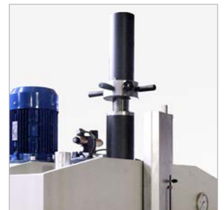
Regulación mecánica del cilindro
