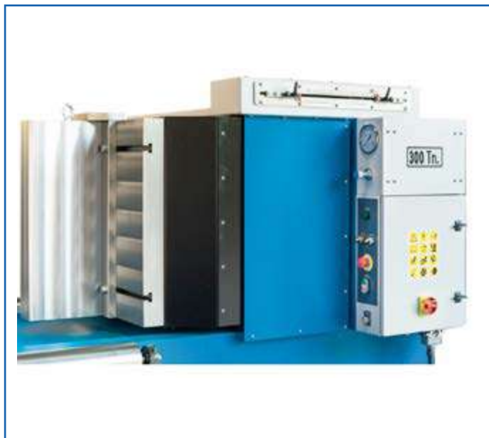
Cuadro eléctrico y panel con finales de carrera.
