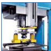
FDM-80/3 E dotada de tres cabezales independientes.
