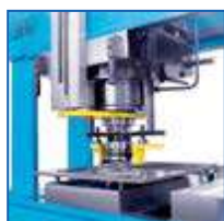
FDM-80/3 E dotada de tres cabezales independientes.
