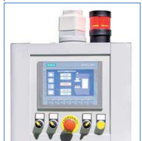
PLC SIEMENS mod. SIMATIC S7 1200 con pantalla táctil de 7" mod. KTP-700.
