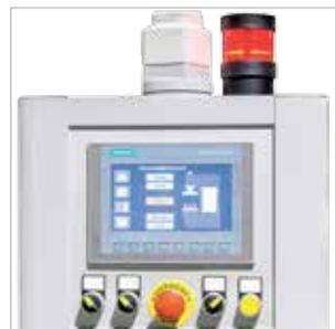
NC SIEMENS SIMATIC con pantalla táctil KTP-700
