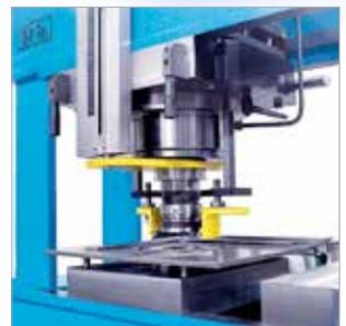
Stanzwerkzeug für Durchmesser von 6 mm bis 160 mm
