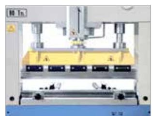
Abkantwerkzeug mit einer Länge von 1.020 mm
