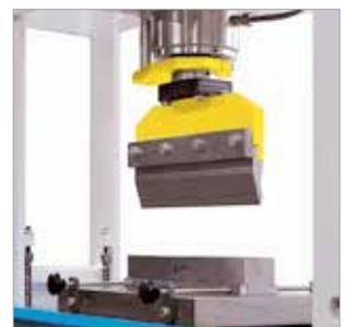
Abkantwerkzeug mit einer Länge von 415 mm
