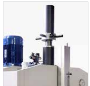
Regulación mecánica del cilindro
