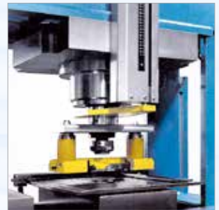
Equipo de punzado para diámetros desde 6 mm hasta 40 mm con pisador elástico antideformación
