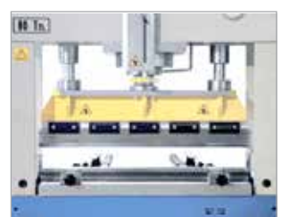
Equipo de plegado de 1.020 mm de longitud
