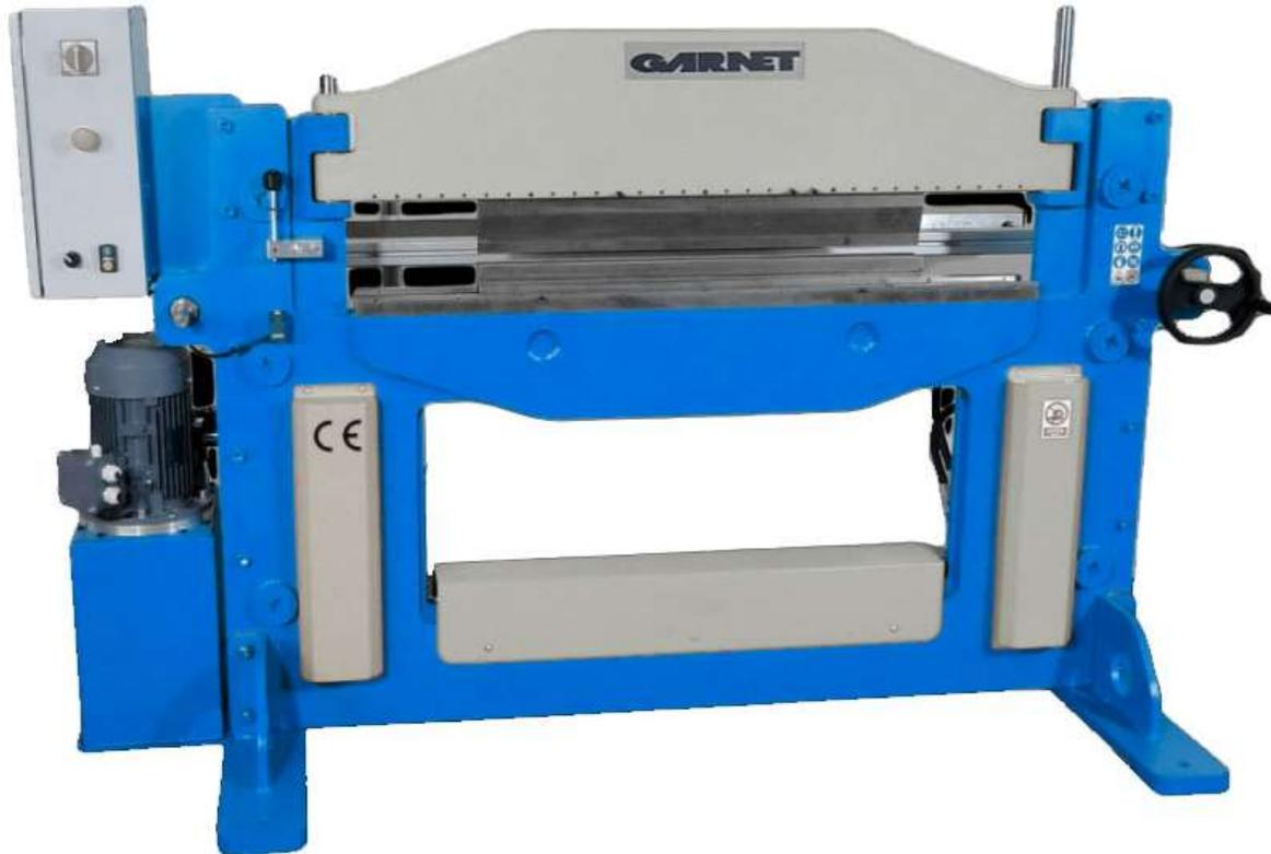
La prensa plegadora de taller GARNET modelo CPB-1232 es una máquina pensada y diseñada para los talleres de cerrajería.
