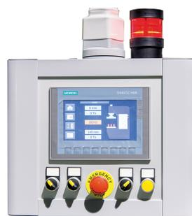
Elektronische Pressensteuerung mit Siemens Touch Panel Typ MTP-700
