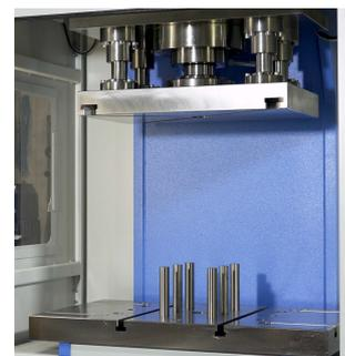
Unterzylinder hydraulisch als Zieh- oder Auswerfer steuerbar
