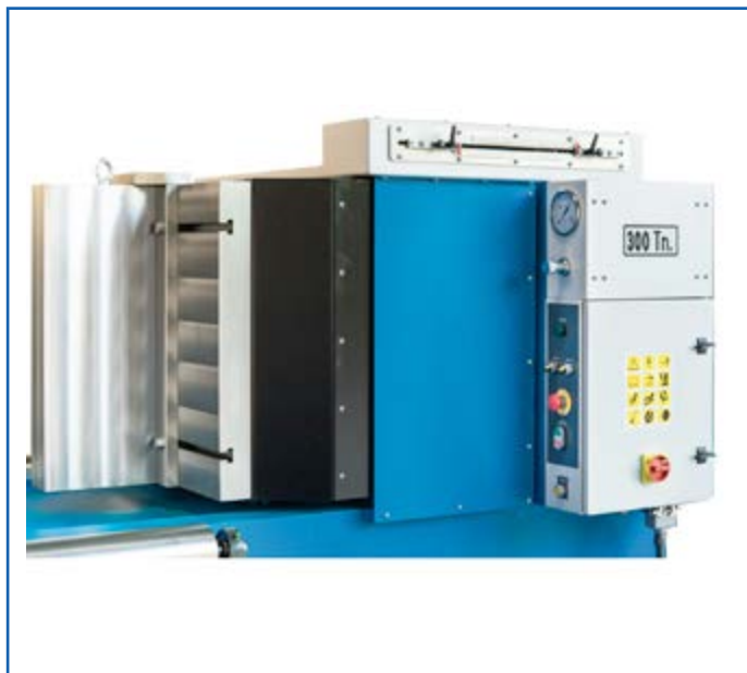
Skrzynka elektryczna, panel z krążkami skoku
