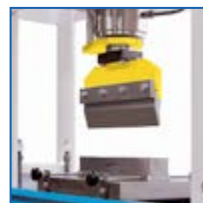
FLM-100 z jedną głowicą obsługującą trzy matryce.
