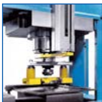
FDM-80/3 E wyposażona w trzy niezależne głowice.
