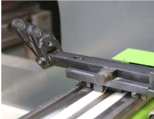
Topes escamoteables para evitar colisiones en plegados "Z" inversos.
