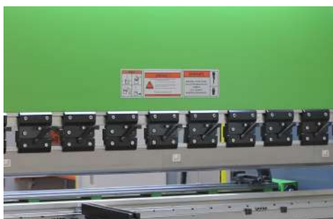
Amarre Promecam. Compensación de flexiones por cuñas.
