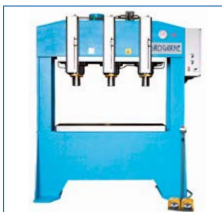
FDM-80/3 E dotada de tres cabezales independientes.
