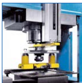
Equipo de punzonado para diámetros desde 6 hasta 40 mm con pisador elástico antideformación.
