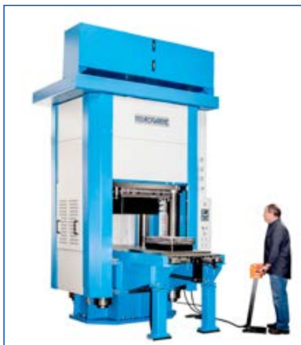
Modelo MV-600 E para elastoconformado.
